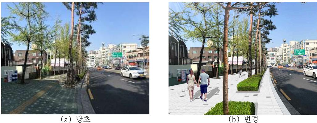
<그림 3-34> 차로폭원 축소 설치 예시도
