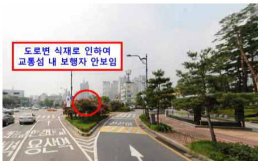
<개선 전> 지장물에 의한 시야 미확보
